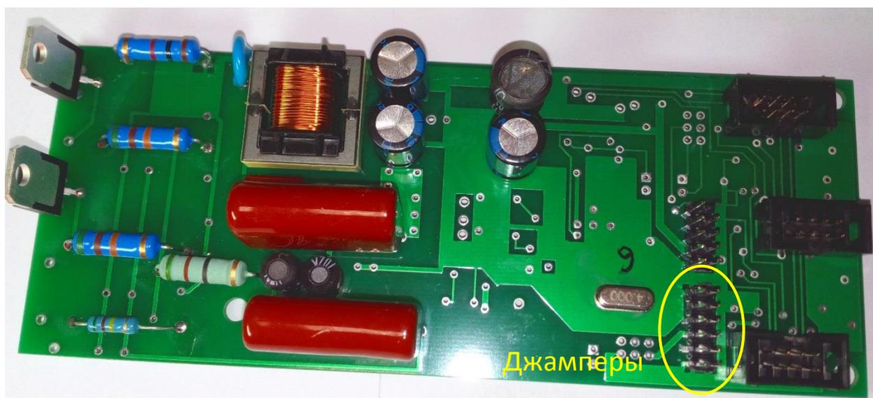
Джамперы находятся на краю платы. Заводская установка – адрес 0. Джампер типа платы соответствует типу светофора (0-транспортный, 1-пешеходный).
