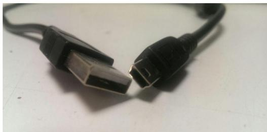
Также для записи конфигурации в контроллер, можно использовать специальный кабель программирования производства ООО «Комсигнал».
