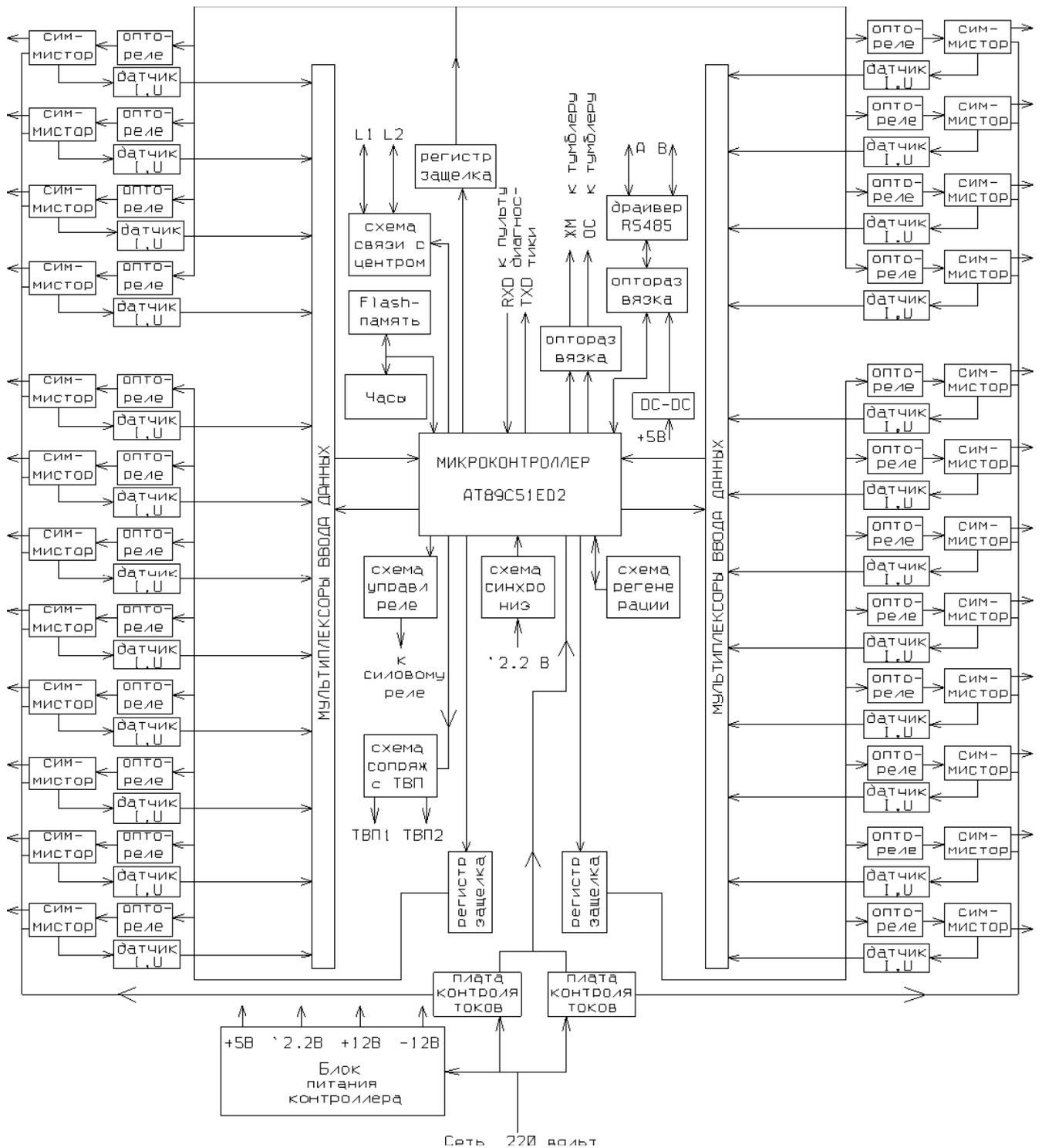
микроконтроллера. Если напряжение сети меньше 160 В, то импульсы на выходе компаратора отсутствуют, и микроконтроллер будет находиться в ждущем режиме с отключением всех выходов до нормализации напряжения сети.
