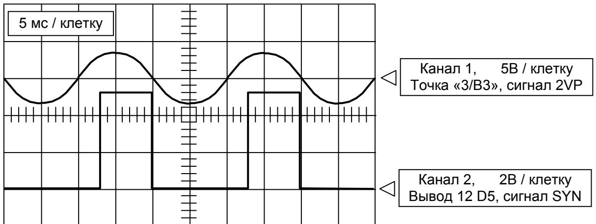
Через 1...2 секунды после сброса при наличии сигнала SYN начинает вырабатываться сигнал EQP и EQ (скважность этих сигналов приведена для версий программы контроллера kdu3m01 и более поздних ).
