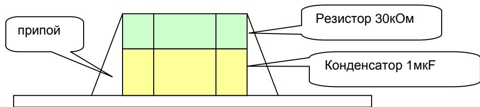
**Доработки на дополнительных платах токовых трансформаторов**
