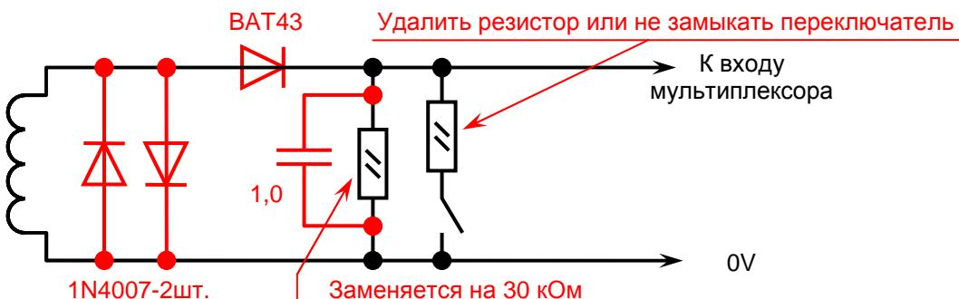
Фактически это схема пикового детектора. Поэтому дистанционный замер токов в каналах после доработки становится неинформативным и практического смысла не имеет. Аппаратный переключатель «лампы/светодиоды» после доработки всех красных контролируемых выходов должен быть установлен в положение «светодиоды» (если резистор для лампового режима не удален).
