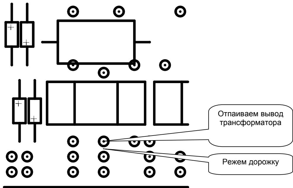
Устанавливаем диод BAT43, к аноду припаиваем вывод трансформатора (отпаянный выше)
