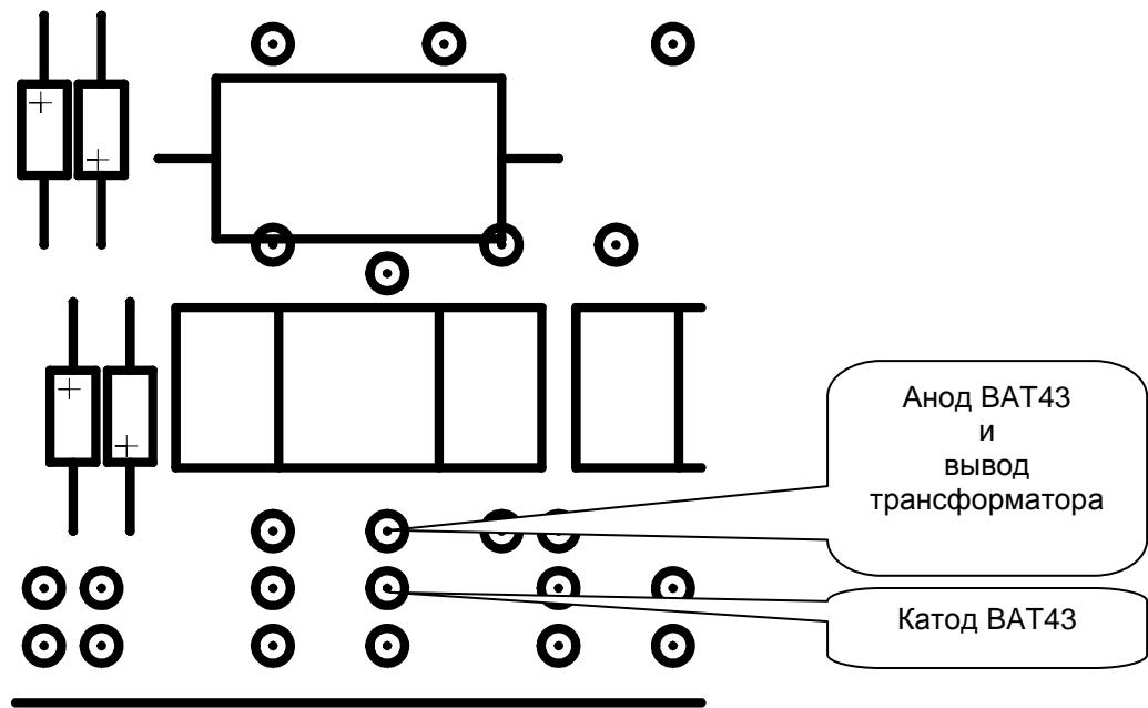
На **ОБРАТНОЙ** стороне платы параллельно трансформатору припаиваем пару диодов 1N4007, включенных встечно-параллельно
