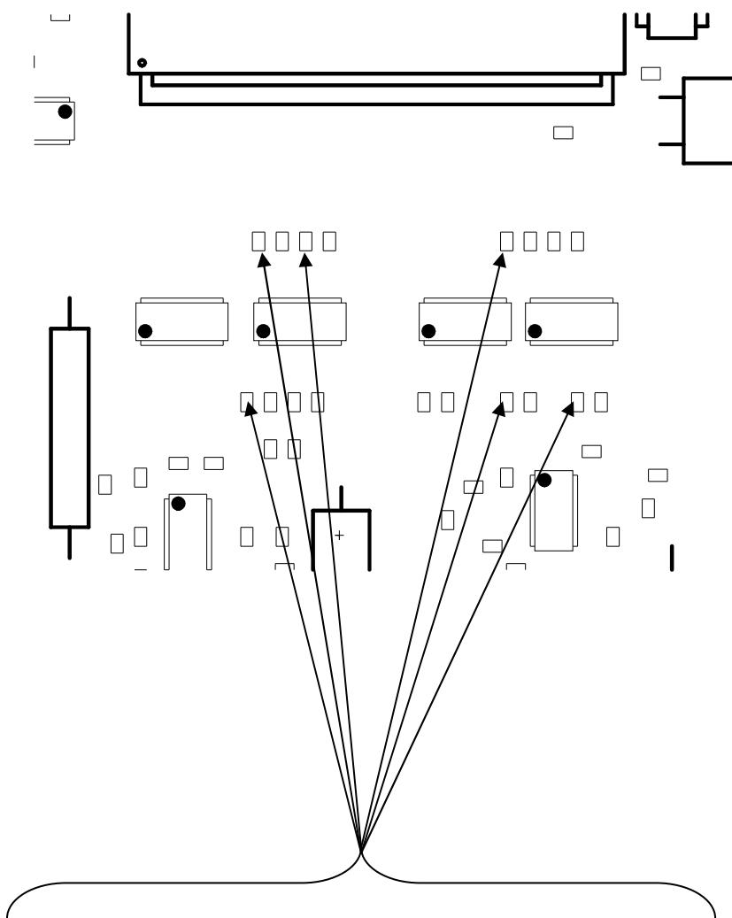
Резисторы, отмеченные на рисунке выше, меняем на: конденсатор 0805-1мкF + резистор 0805-30кОм.
