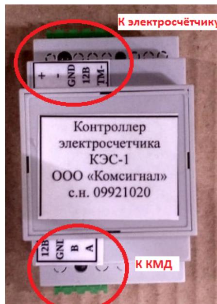
Для каждого типа счетчика в КЭС записывается своя прошивка (Маяк, Энгергомера, Меркурий и т.д) доступна на сайте:
